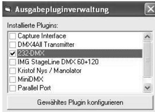
werden kann müssen die Dateien **if32.dll** und **if32plugin.out.dll** in das Programmverzeichnis unter dem DMXControl installiert ist kopiert werden. Danach kann der Umsetzer an einem beliebigen freien COM Port angeschlossen werden. Dann müsste man nach Starten des Programms unter Ausgabe-plugins einen Eintrag mit dem Namen 232 DMX finden so wie das nebenstehende Bild zeigt. Wenn das Häkchen bei 232-DMX gesetzt ist kann man unter gewähltes
